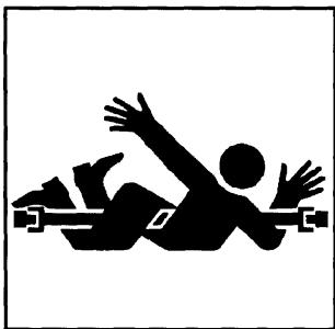
A. 8. 9 机具动力输入传动轴缠绕整个身体。
