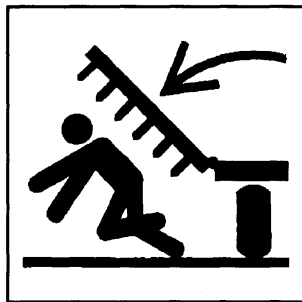
A. 6. 12 种植器或谷物播种翼板造成挤压。
