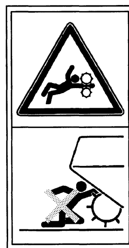
C. 2. 46 拖拉机发动机运转且动力输出轴接合时,禁止进入捡拾区。
