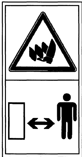
C. 2. 38 远离割台。维修或清理割台前,分离割台传动装置、发动机应熄火并拔下钥匙。
