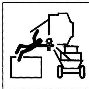
A. 8. 20 采棉机输送传动装置缠绕危险。
